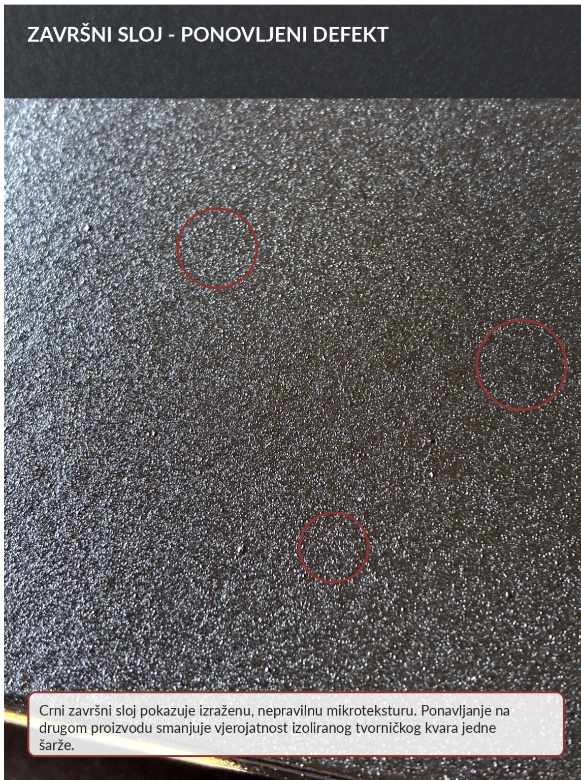
Slika 5. Završni poliuretanski sloj: ponovljena nepravilna mikrotekstura nakon brušenja i ponovne aplikacije.
